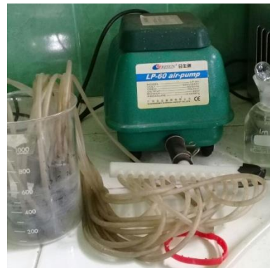
Alat untuk aerasi (aerator)
