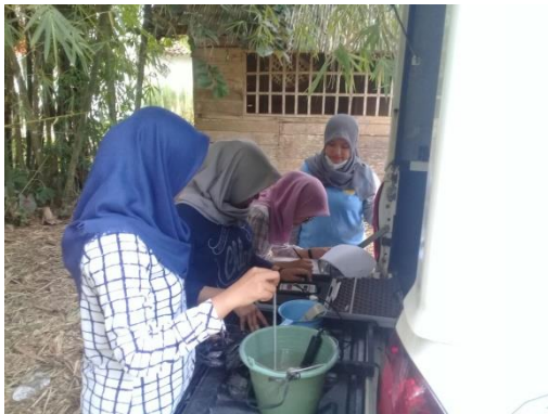
Pengukuran suhu, pH dan DO menggunakan termometer, pH-meter, dan DO-meter
